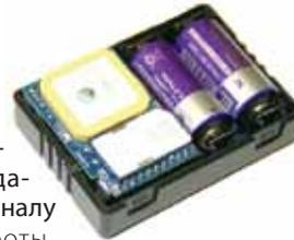
Автономное поисковое устройство с функцией определения GPS-координат, передачей информации через GSM-сеть по SMS-каналу и длительным автономным режимом работы.
